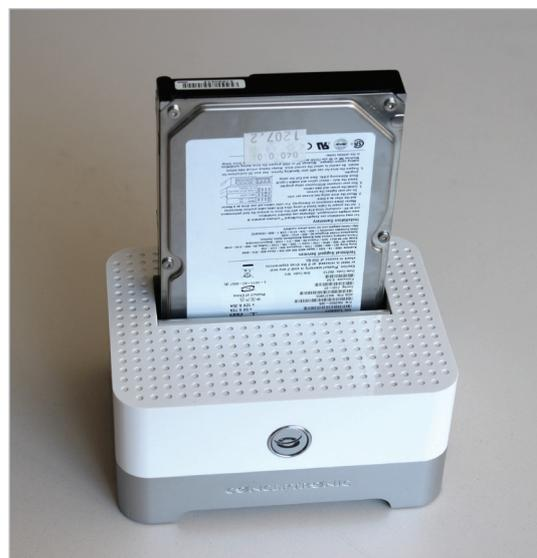
Figura 8. Docking station con un disco SATA insertado
