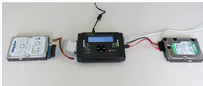
Figura 9. Duplicador de discos con sistema write-blocked. En este caso está realizando una copia fidedigna del contenido de un antiguo disco duro IDE en un nuevo disco duro SATA
