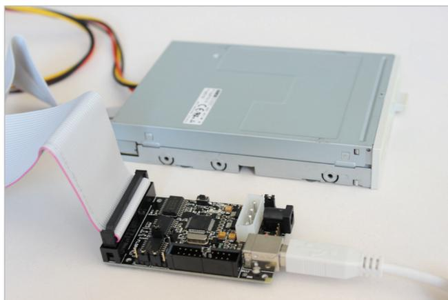
Figura 6. Tarjeta *KryoFlux* conectada a una disquetera de 3,5"
