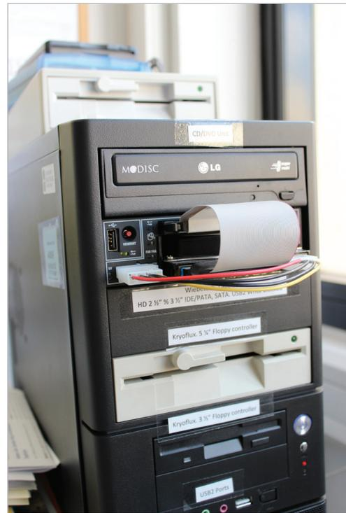
Figura 2. Torre de análisis forense creada a medida a partir de varios componentes
